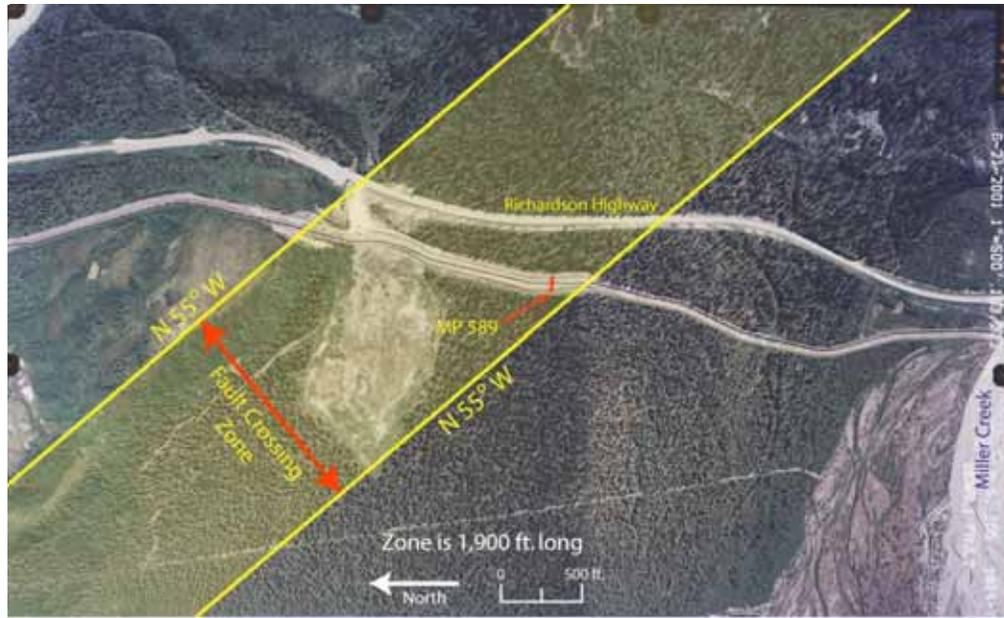
Figure 3.10. Denali Fault Crossing Zone (Alyeska)
